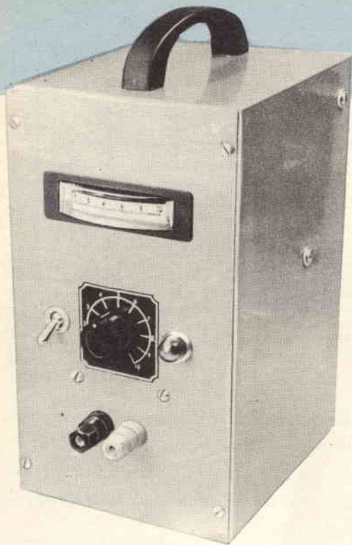
Ecco come appare il caricabatterie ultimato. Nelle fotografie non sono visibili due fori da 2 cm ciascuno praticati sul fondo e sul pannello posteriore e guarniti di griglie per la ventilazione.
