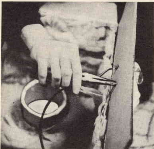
Prima di rivestire la scatola di materiale fonoassorbente incollate il condotto su uno dei fori. Montate i terminali e collegateli all'altoparlante.
